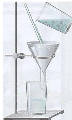
**6. На рисунке показаны приборы, используемые для дистилляции воды в лаборатории. Определите рисунок с ошибкой. Ответ обоснуйте.**
